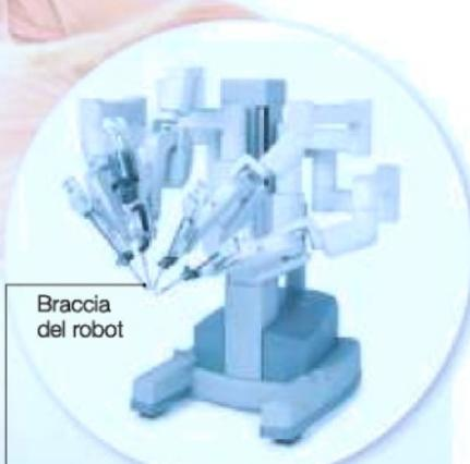
3 Attraverso l'incisione si introducono una microtelecamera e gli strumenti collegati alle 4 braccia del robot. La telecamera fa vedere ogni movimento per intervenire con precisione sulla tiroide
